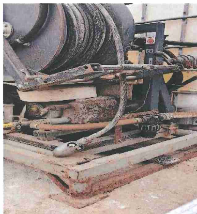
Slika 3: Naprava koler za odmaševanje kanalizacijskih cevi
