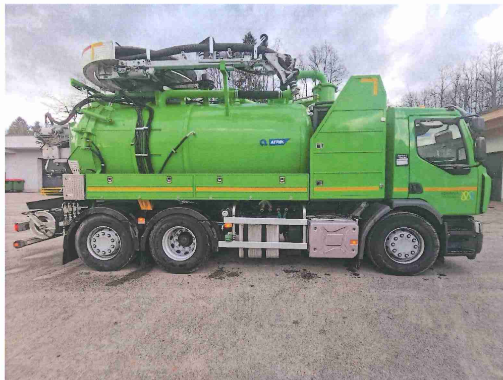
Slika 2: Specialno vozilo za čiščenje kanalov in prevoz odpadnih voda
